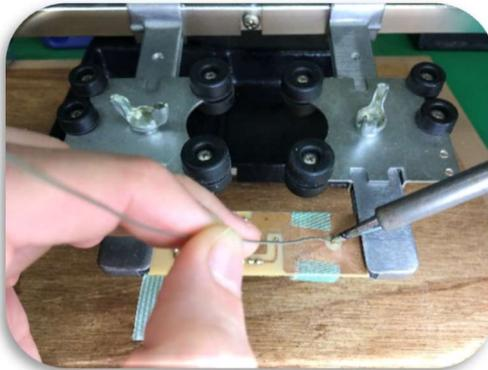
② 電子部品の足付近にはんだの先端を接触させる。
