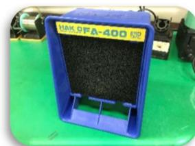
④ 排煙装置は作業位置の近くに置き、はんだを熱したときに出る煙は、吸わないようにしましょう。
